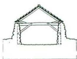
Fig. 14. Grindabygd naust med steinvegger. Nord-Varhaug. Hå kommune. Oppmålingstegning: Arild Wåge/Helge Schjelderup.
